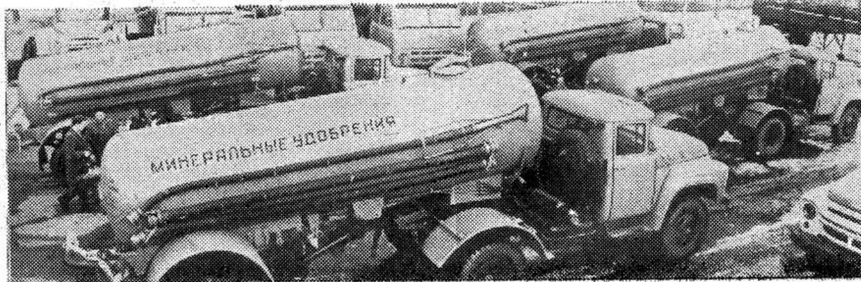
НА СНИМКЕ: автомобили-разбрасыватели удобрений («АРУП-8») на отгрузочной площадке завода. Фото Н. Акимова. Фотохроника ТАСС.
